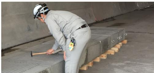
写真-1 標準供試体の一例
