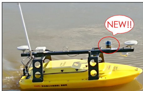
図-1 ボートの概要(陸上部スキャナ設置)
