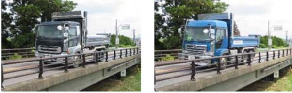
写真-1 使用したダンプ（総重量 20t と 12t）
