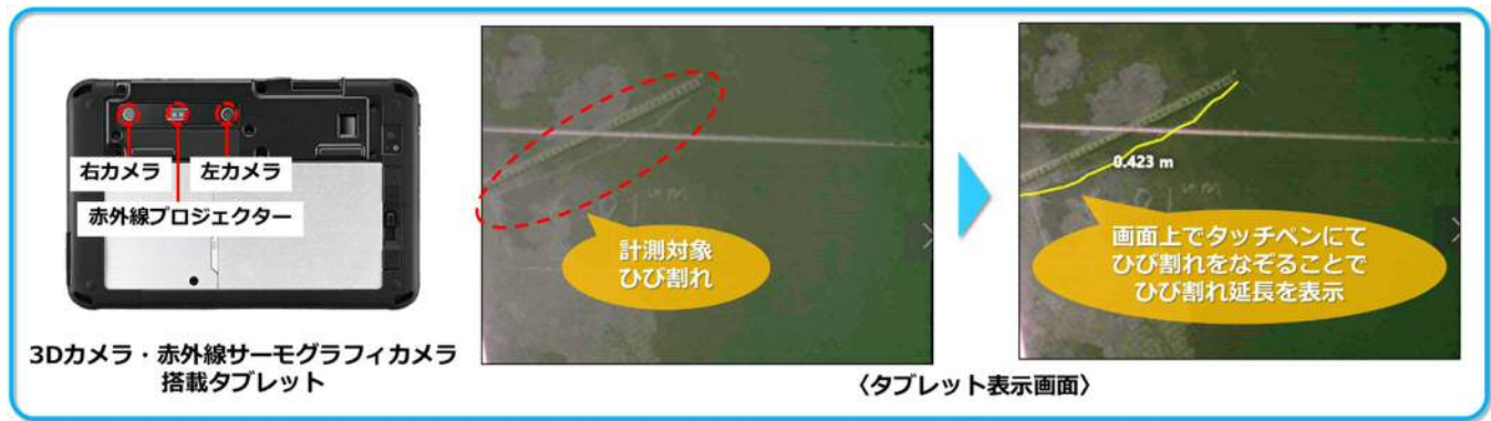
図-2 3D カメラ技術を活用したひび割れ延長計測概要
