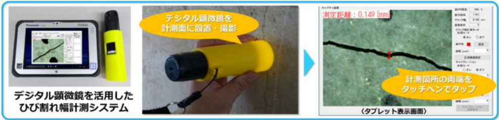
図－1 ひび割れ幅詳細計測機能概要
