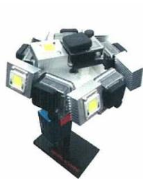
図-1 構造物点検用パノラマカメラ
