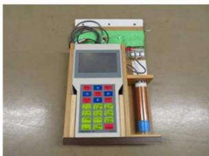
写真3 永久磁石式全磁束装置
