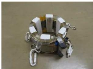
写真2 ECT装置（左：貫通型センサー 右：探傷器）
