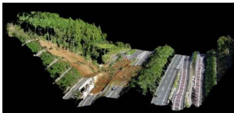
図2. 3次元モデルによる再現（左：ドローン画像、右：航空レーザー点群データ）
