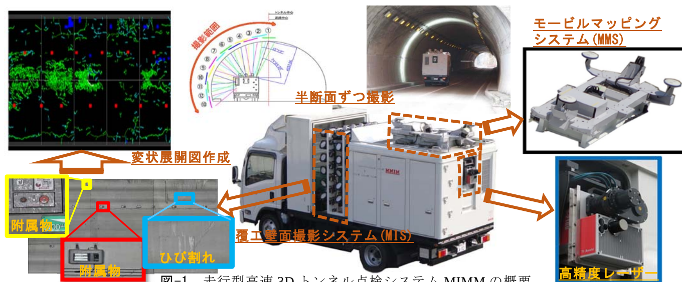
図-1 走行型高速3Dトンネル点検システムMIMMの概要
