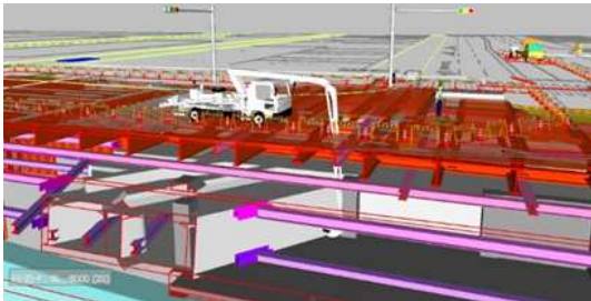
図-3 重機配置計画モデル
