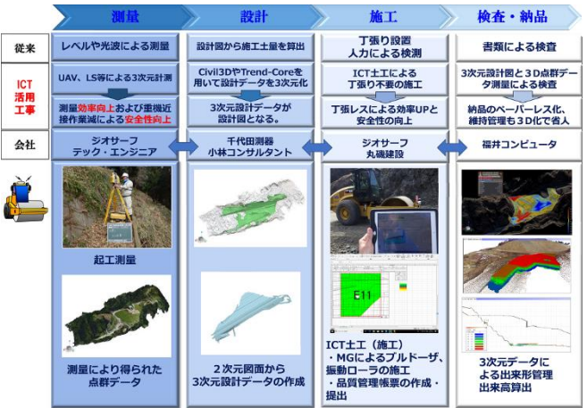
図－1 3次元による一貫通貫の取り組み
