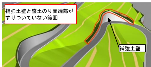
図－5 ランプ部不整合箇所
