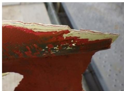
図-4 「IH工法」で除去した塗膜の状態
