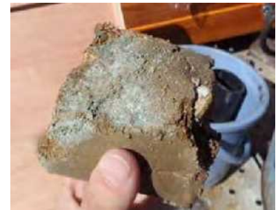
写真-1 固結粘土状の土塊
