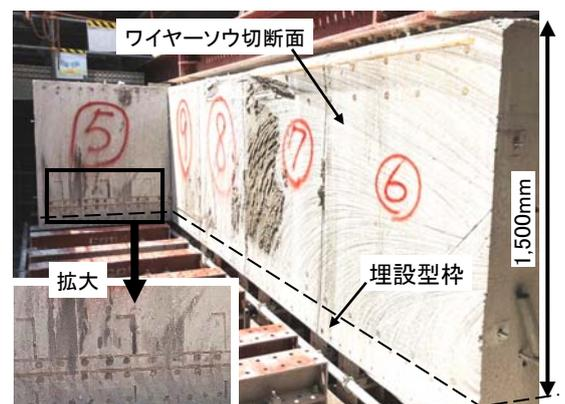
写真-3 ワイヤーソウ切断面の充填状況
