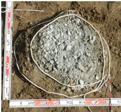
図 4 出来形径の掘削確認
