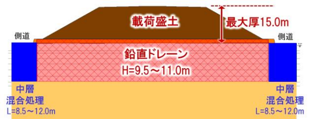
図-3 中層混合処理工施工断面図
