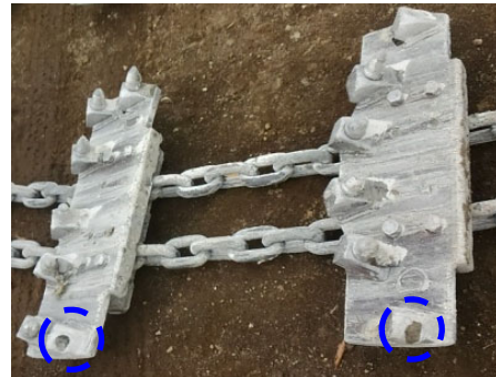
写真-4 破損したビットプレート
