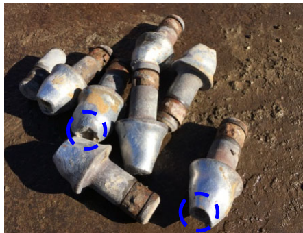
写真-3 摩耗・破損したビット
