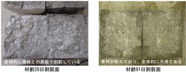
写真-1 引張強度試験後割裂面
