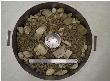
写真-2 受皿内の砂礫材料表面の状況例
