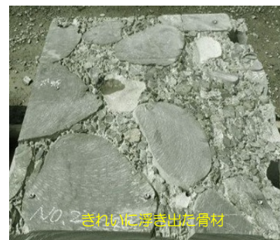
写真-1 超高圧ジェット水圧 200MPa による処理状況
