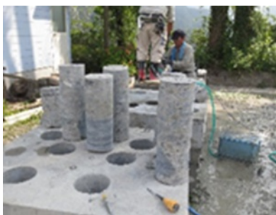
写真-2 一体化試験コア採取
