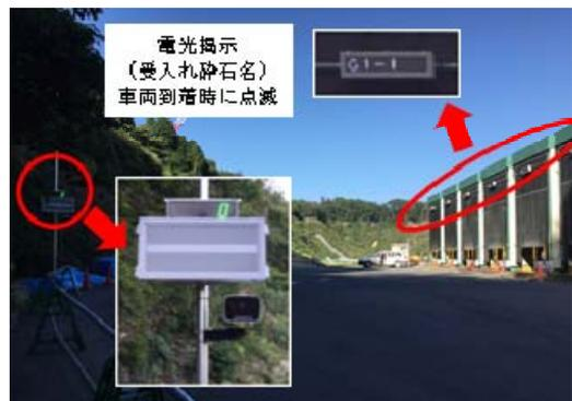
図-5 車両誘導システム設置状況
