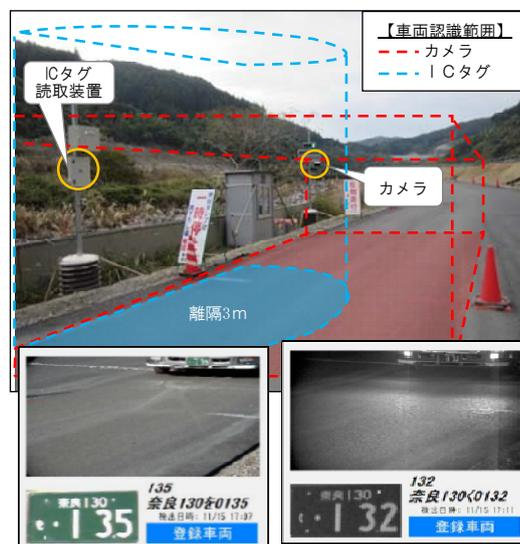
図-4 カメラによる車両認識
