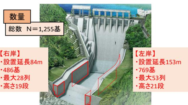
図-1 側壁 Pca ブロック範囲図
