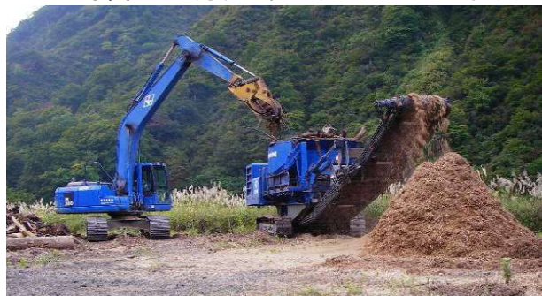
写真-3 伐採木のチップ・堆肥化実施状況
