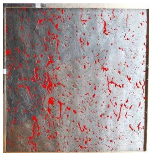
写真-4 気泡発生状況 (A部)
