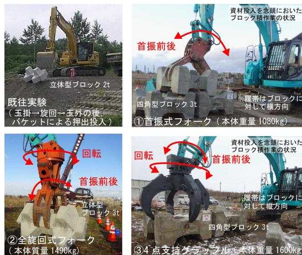
図-1 既往投入実験および本実験で用いたグラップル
