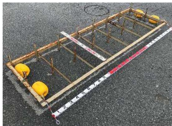
図-4 突棒治具用のガイドフレーム
