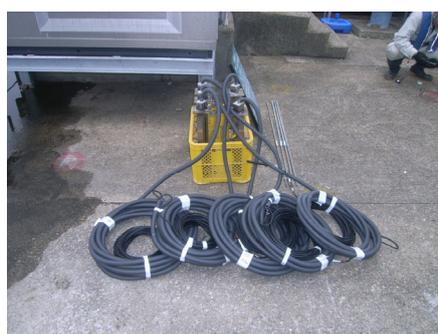
写真-4 埋設型傾斜計
