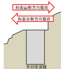
図-1 深礎の载荷方向
