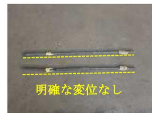
写真3 補強鉄筋の変位
