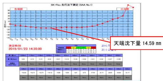
図-7 先行沈下計経時変化図
