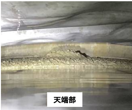
写真-4 高流動コンクリートの流動状況
