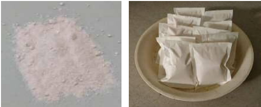
写真-1 流動化剤の外観(左)と水溶紙での梱包(右)
