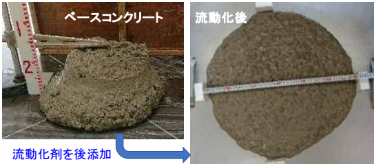
写真-2 流動化前後のコンクリートの外観
