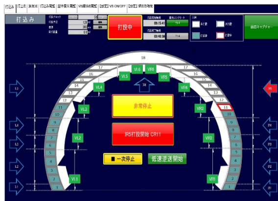
図-2 覆工自動施工システムメイン画面
