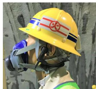
図-1 トンネル作業環境下における骨伝導ヘッドセットの装着状況
