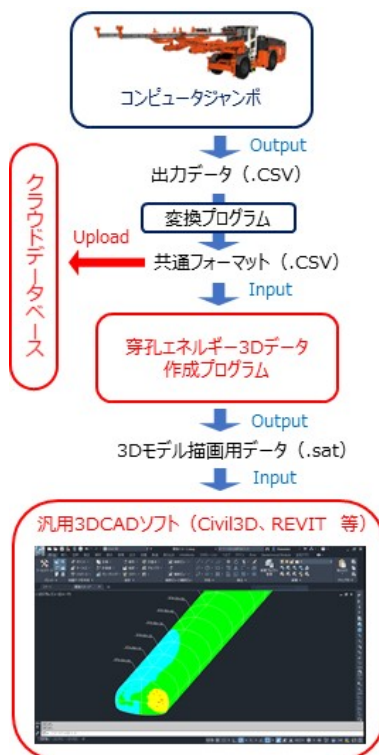
図-5 穿孔エネルギー 3D 分布図作成フロー
