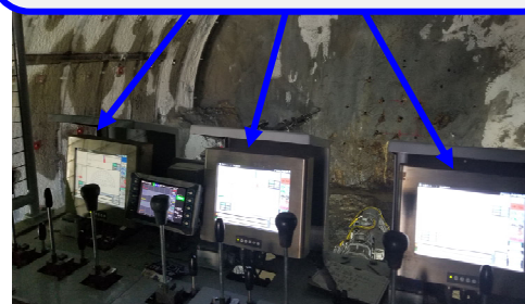
図-2 マシンガイダンス画面
