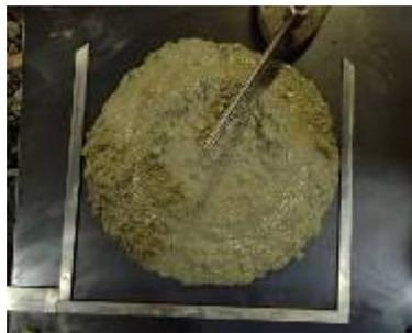
写真-1 T3-4(Ad)スランプ試験結果
