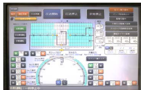
写真-3 打設制御システムのモニター画面
