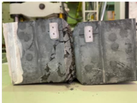
写真 1 载荷後の試験体 (UFC-4)
