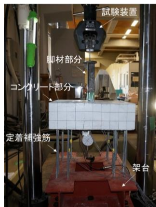
写真1 試験体据付状況
