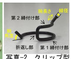
写真-2 クリップ型の固定部材
