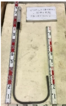
写真-3 GFRP ロッド曲げ成形部 試験体
