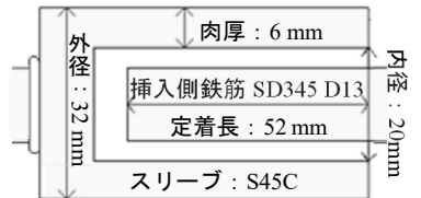
図-1 継手の各寸法
