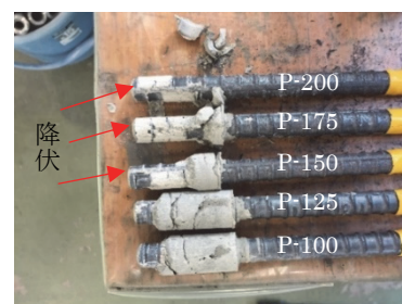
写真-2 破壊の状況 (下から P-100, P-125・・・)
