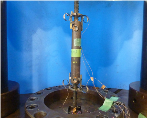
写真-3 疲労試験状況
