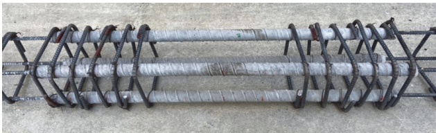
図-2 軸方向鉄筋を UHP-SHCC で被覆した状態
