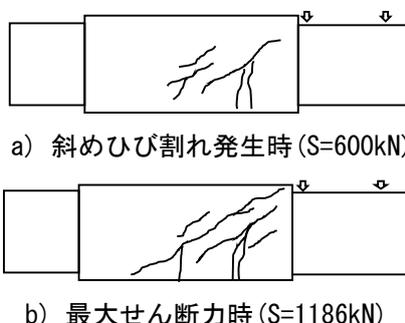
図7 損傷状況 (載荷試験)
