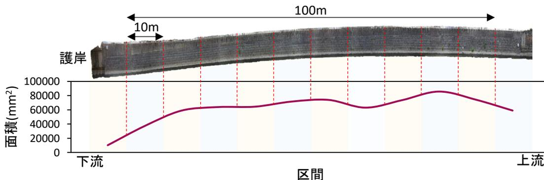
図-6 区間別のひび割れ面積の評価
