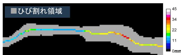
図-4 ひび割れ計測結果
