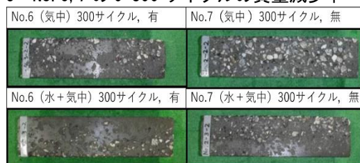
写真-1 特殊混和材の有無による凍結融解試験 300 サイクル時の供試体表面の状態
