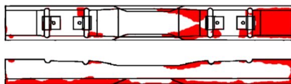
図 4 スケーリング箇所の抽出例（赤い部分がスケーリング箇所）
