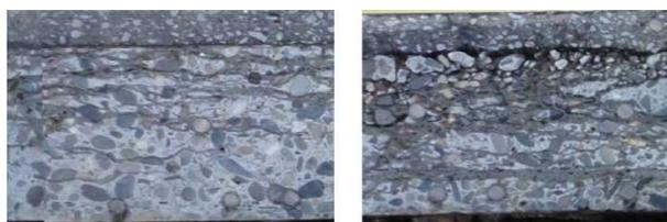
写真-2 疲労と凍害の複合劣化を受けた床版の断面<sup>2)</sup>
