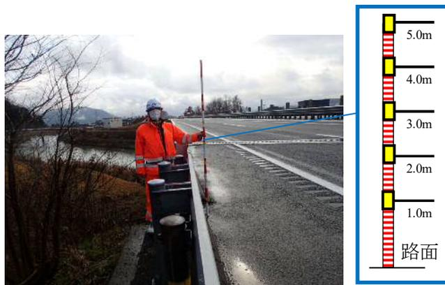
写真-3 感水試験紙の設置状況
