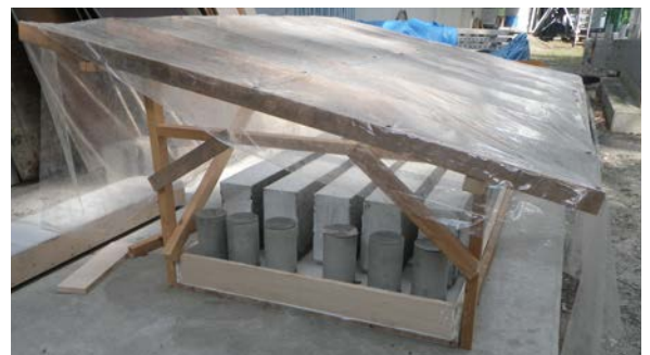
図-1 塩水吸い上げ状況
